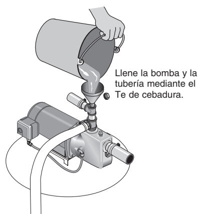
Figura 9: Cebadura de la bomba
